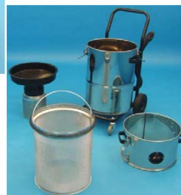
Aufbau des Spänesaugers
